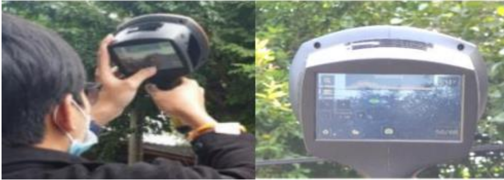
Fig.1 – Detecção de DP usando câmera acústica
