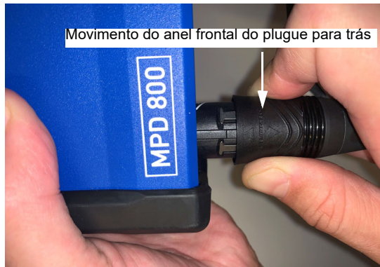
Figura 2-20: Desconexão do cabo de fibra óptica
