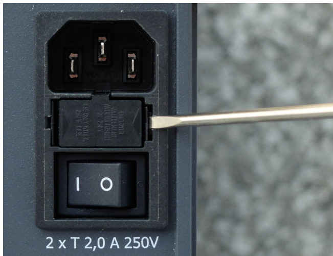
Figura 11-1: Destravamento das linguetas de travamento do suporte de fusível
