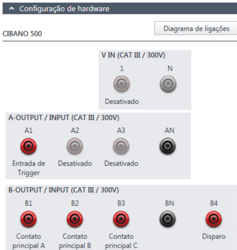
Figura 19-2: Configuração de hardware do Teste de primeiro disparo
