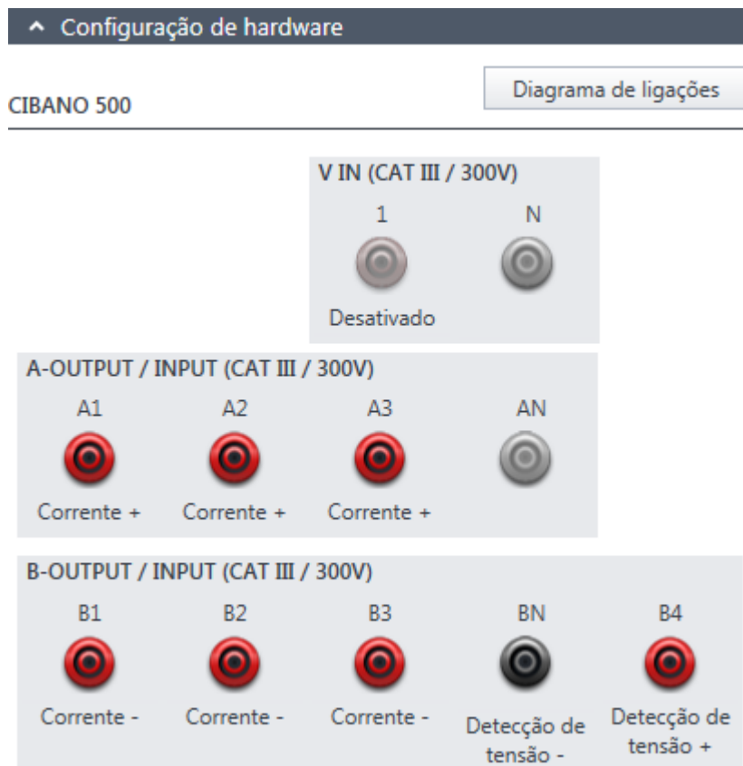
Figura 18-50: Configuração de hardware da desmagnetização
