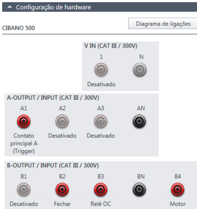
Figura 18-14: Configuração de hardware do teste de liberação de sobrecorrente
